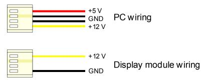
Figure 2-6 Wiring for 12 volt modules
